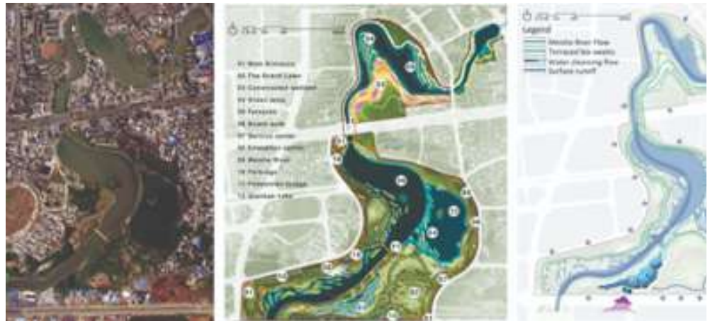
Ilustración 2. Ciudad de Haikou, 2016. Transformación de la canalización con muros de contención en concreto en una forma de infraestructura ecológica para adaptarse y mitigar el cambio climático, Fuente: Turenscape.
