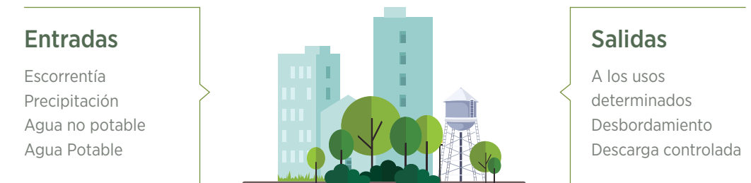
Figura 9. Entradas y salidas para el balance hídrico por componente para almacenamiento y reúso
